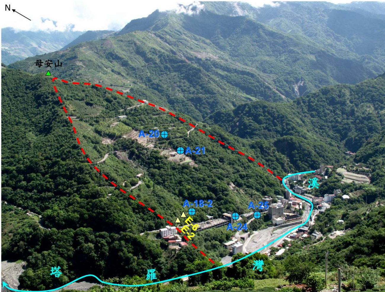
南投廬山溫泉北坡細部監測儀器配置圖 (林錫宏 提供)
